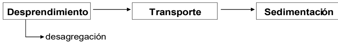
Figura 14.20. Etapas del proceso de erosión.
