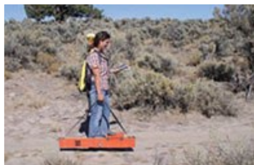
Figura 21.9. (a) Equipos electromagnéticos de fuente controlada (EMI) http://www.geonics.com/html/em38.html y Doolittle y Brevik (2014) y (b) Principio de funcionamiento. Adaptado de Allred et al. (2008).
