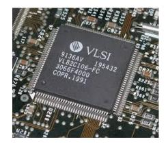
El progreso continuo de las técnicas de integración permitió la realización de circuitos de muy gran escala de integración (VLSI), de ultra gran escala de integración (ULSI) y de giga gran escala de integración (GLSI) que llegan a contener más de 1.000.000 de componentes (equivalentes aproximadamente a 100.000 puertas) en su interior.
