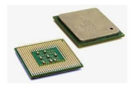
**ULSI (ULTRA LARGE SCALE INTEGRATION):** Tecnología de circuitos integrados que utiliza entre 100.000 y un millón de transistores por circuito integrado, equivalentes a 10.000 y 100.000 puertas lógicas. Actualmente se utiliza para fabricar microprocesadores complejos.
