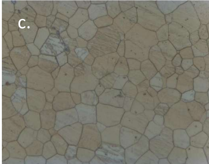
Figura 24. Micrografías luego de ataque con acético-picral. Con aumentos de: (a) x10; (b) x20 y (c) x50.
