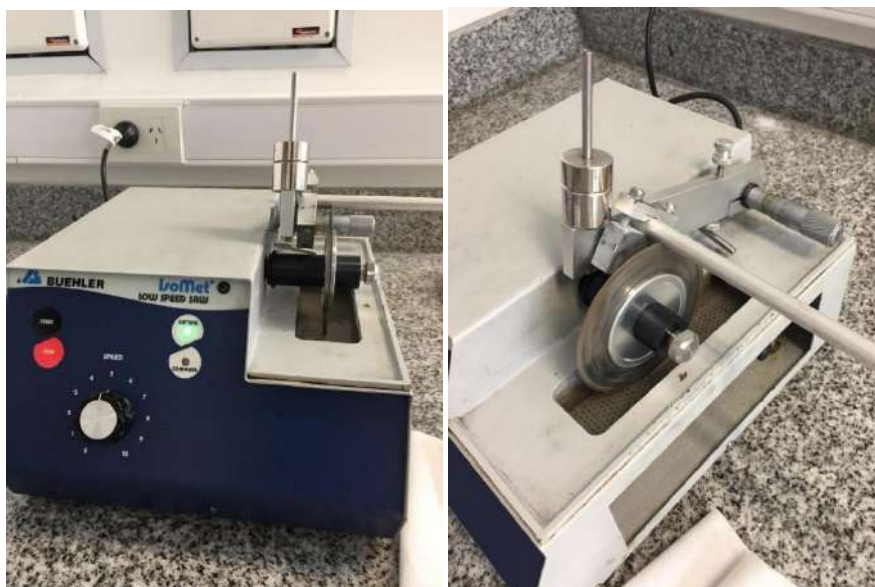
Figura 14. Sierra eléctrica de baja velocidad IsoMet (Buehler), junto con cilindro macizo de Mg.
