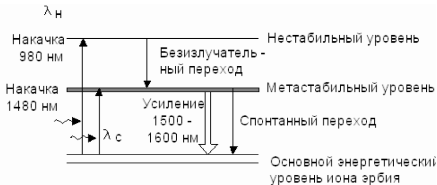
Рисунок 2. Уровневая диаграмма переходов трехвалентного иона эрбия
