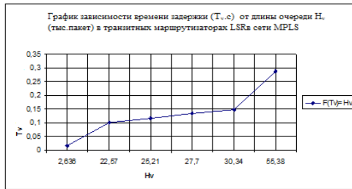
Рисунок 10. График зависимости времени задержки ( T_v ,с) от длины очереди H_v (тыс.пакет) в транзитных маршрутизаторах LSR в сети MPLS
