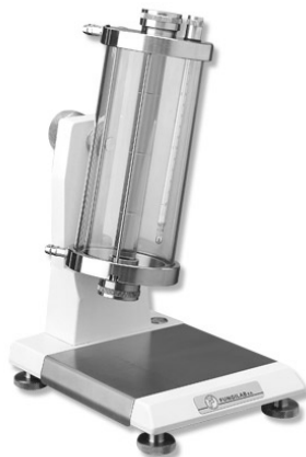
FIGURA 16. Viscosímetro de caída de esferas, viscosímetro de Hoeseppler.
