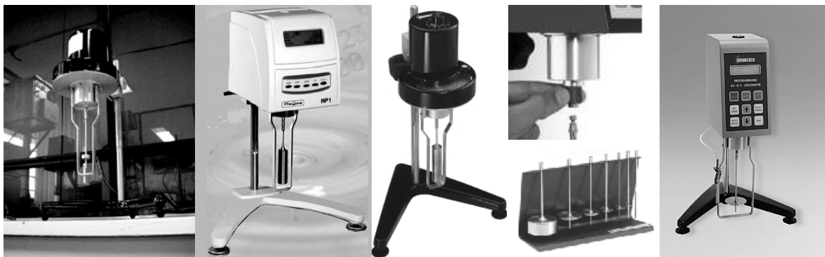
FIGURA 20. Viscosímetros de Agujas (Brookfield).
