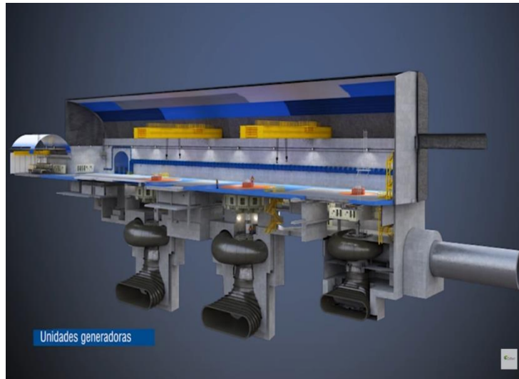
Figura 1.18. Turbinas de la central hidráulica angostura, Biobío. Fuente: Página web de Colbún S.A.
