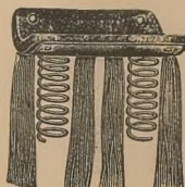
Schmierpolster mit Ölsauger und Docht.
