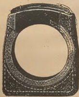
federnder Filzring für geschlossene Achsbuchsen der kgl. Preuß. Staatsbahn.
