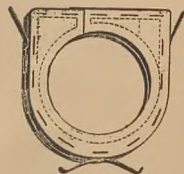
Magdeburger Dichtungsringe aus weißem Wollfilz.
