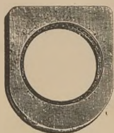
Holzring mit Filzeinlage, für Verbandsachsbuchsen C 2.
