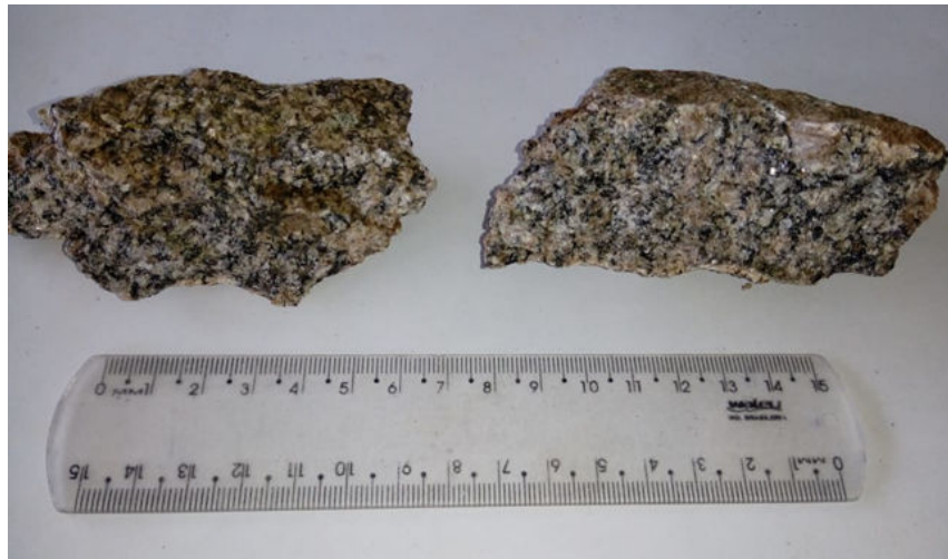
Figura 4. Hiperstênio gnaiss do Complexo Machado com textura lepidoblástica/granoblástica e estrutura gnáissica. Mineralogicamente apresenta quartzo, feldspato, biotita e hiperstênio
