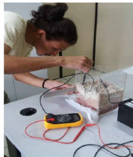
Figura 2 Módulo de resistividade e obtenção dos valores, respectivamente. Fonte: Silva, 2019.
