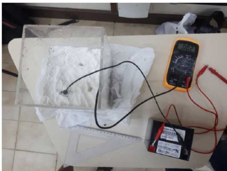
Figura 2 Módulo de resistividade e obtenção dos valores, respectivamente. Fonte: Silva, 2019.
