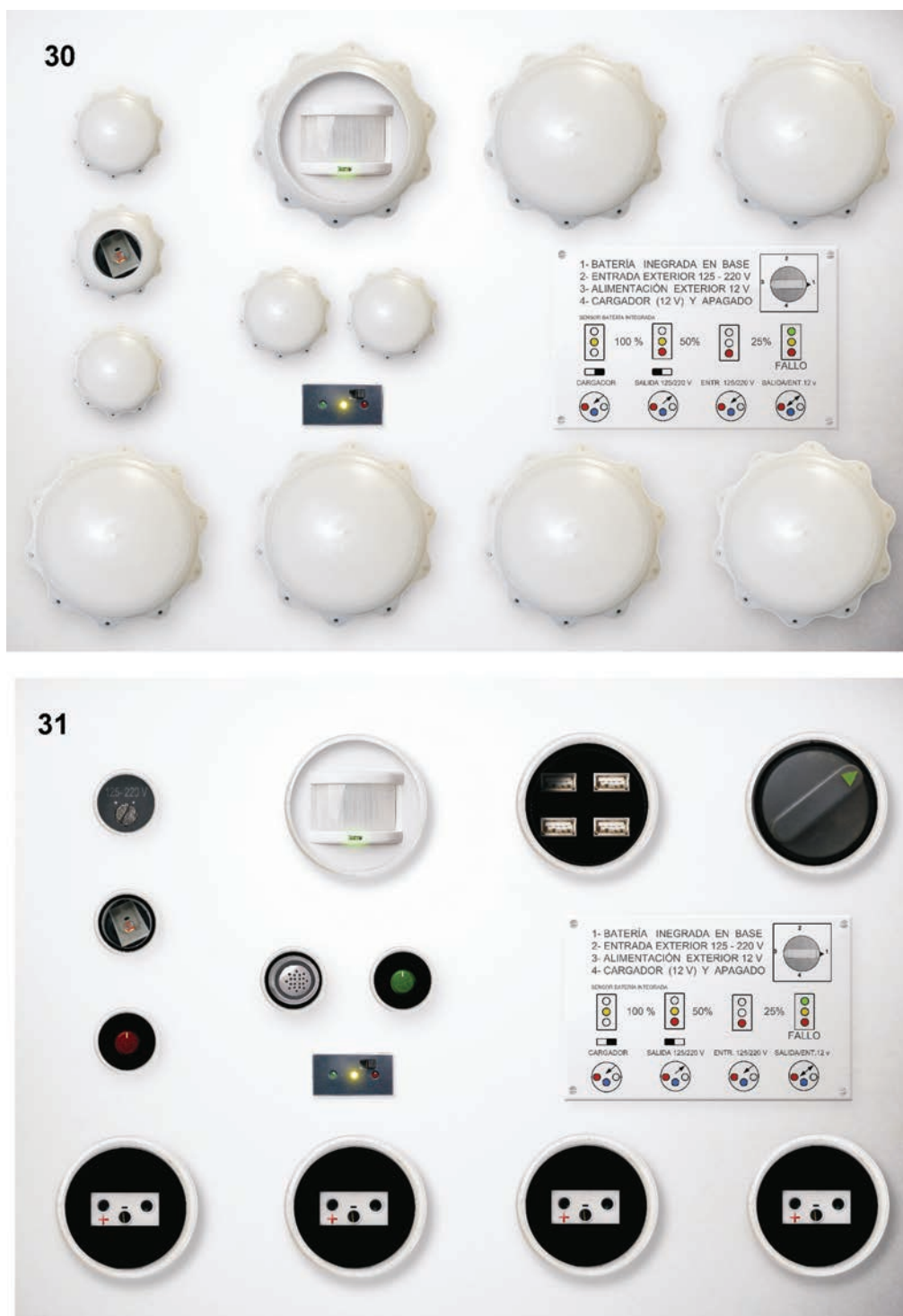
Fig. 30. Parte central del panel de control con todos los mecanismos cerrados. Este sistema con tapaderas de frascos de polivinilo resultó muy eficaz para la estanqueidad. Fig. 31. Parte central del panel de control con todos los mecanismos abiertos. Desde arriba de izquierda a derecha: selector 125/220 V, sensor de proximidad, tomas USB, selector de operaciones, sensor del interruptor crepuscular, buzzer, potenciómetro caudal de sonido, panel informativo, potenciómetro de caudal de luz, sensor de carga de la batería, cuatro tomas, de izquierda a derecha, entrada para la carga de la batería, salida a 125-220, entrada para alimentación exterior a 125-220, entrada y salida a 12V.
