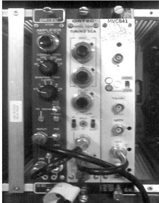
*Figura 76: Vista del escalímetro de velocidad programable montado en un rack NIM a la izquierda del amplificador y el discriminador.*
