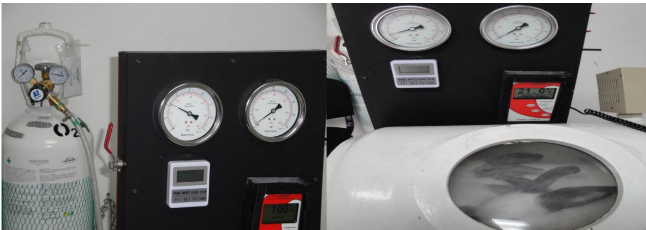
Figura 46. Tratamiento OHB (O 2 100 % 2.4 ATA). Figura 47. Tratamiento Control (Aire 1.3 ATA).
