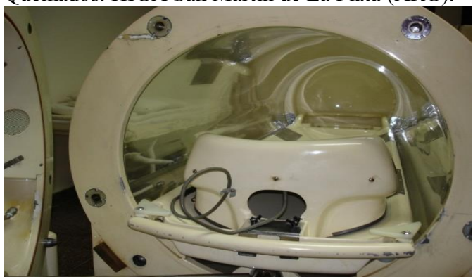
Figura 280. Vista frontal: ingreso de pacientes. Monoplaza HIGA San Martín de La Plata. Figura 281. Vista distal, N° serie y Presión máx: 30 PSIG. HIGA San Martín de La Plata.
