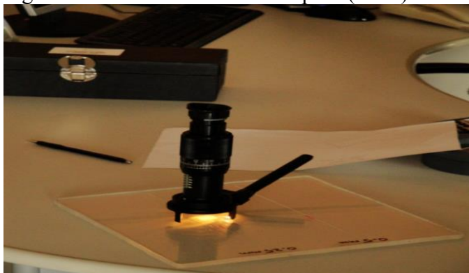
Figura 284. Fisurómetro para Plexiglás ATMO-SAUHMA 2011, Brasil (BR). Figura 285. e.g. Cartucho monoplaza con "crazing", (agrietamiento) del Plexiglás. ATMO-SAUHMA.
