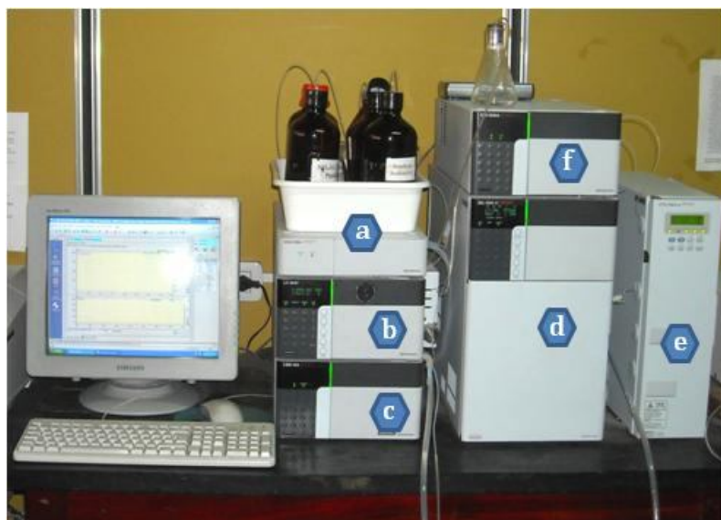
Figura 5.1 Fotografía del Equipo HPLC I. a) Solventes y desgasificador, b) bomba, c) controlador, d) autosampler , e) horno y columna, f) detector UV-Vis.
