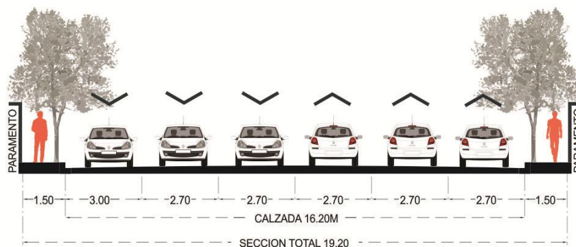
Imagen XI.1.2.5 Sección Colectora 3 carriles por sentido.
