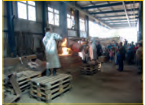
Glockenguss der kleinen Glocke
