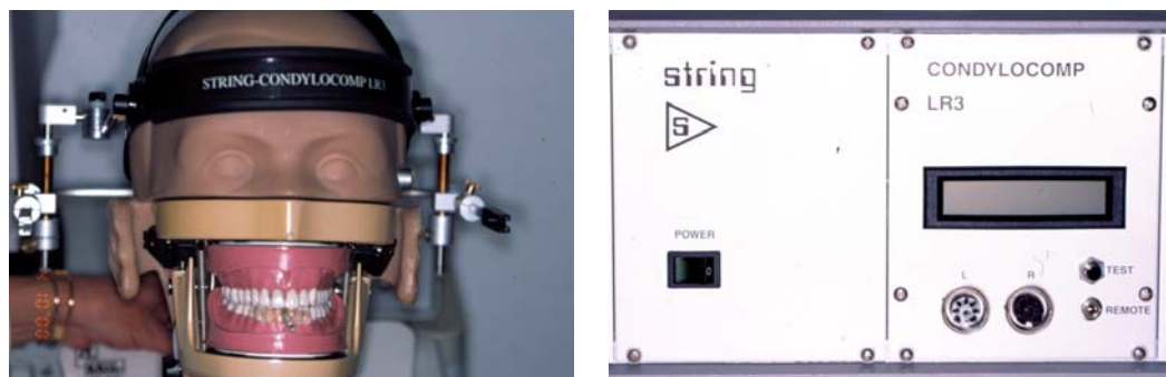
Figura 3.19: Axiógrafo computarizado CONDYLOCOMP.
