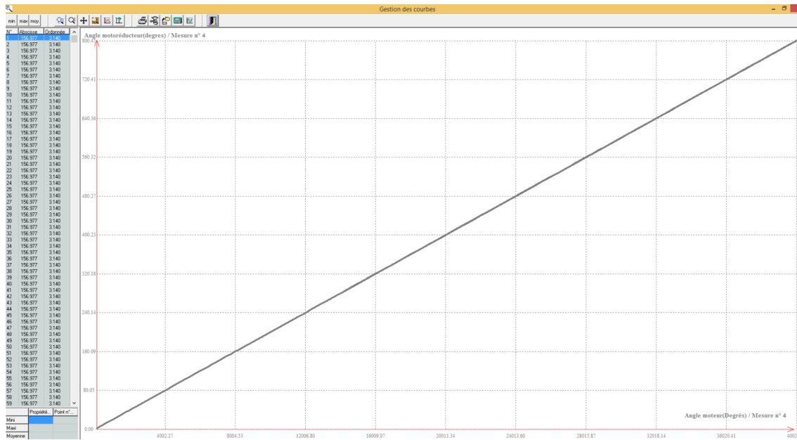
Courbe caractéristique du réducteur de la cordeuse de raquettes
