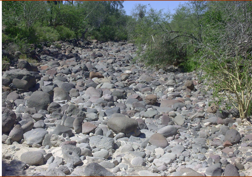
Fotografía 1.- Materiales pétreos que se localizan en el cauce del arroyo San Joaquín. Se encontraron clastos con diámetros promedios de hasta 60 centímetros.
