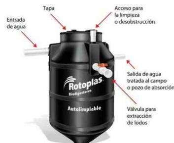
Este sistema tiene su éxito principalmente a que posee un mecanismo de separación de sólidos y una cámara donde se sedimentan, lugar en el que da inicio la fermentación y degradación bacteriana. Este proceso de digestión anaerobia es uno de los procesos más antiguos empleados en la estabilización de lodos. En este proceso se propicia la degradación de la materia orgánica contenida en él en ausencia del oxígeno molecular.
