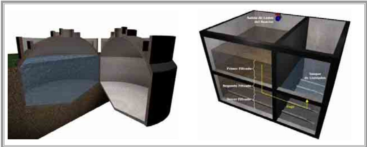
Figura 26. Planta de Tratamiento. Las imágenes corresponden a esquemas del interior los reactores anaerobios híbridos de flujo ascendente (RAHFA), que se presentan con objeto de ilustrar sus características. Fuente: www.aitasc.com .
