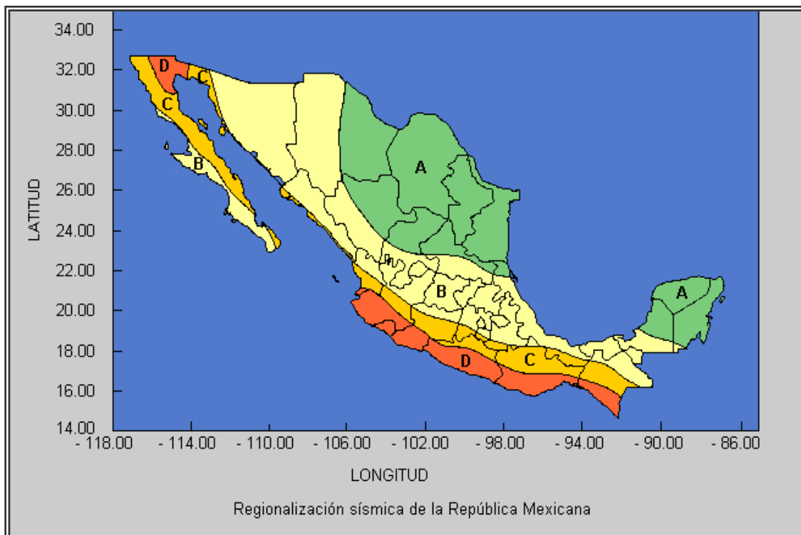
Regionalización Sísmica de la República Mexicana, el área del proyecto se ubica en la zona clasificada como C
