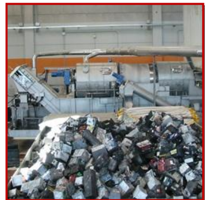
FOTO 29.- Carga de baterías para triturado.
