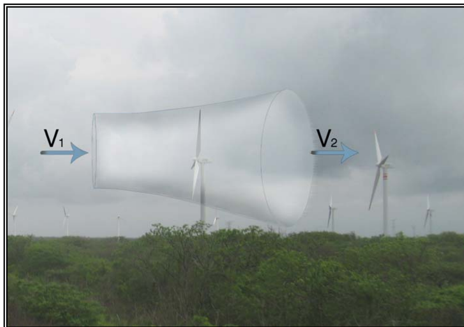
Figura V-10.- Incremento de la velocidad del viento al pasar por las paletas de los aerogeneradores.
