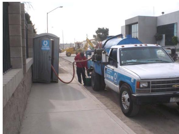
La empresa de sanitarios móviles cuenta con el servicio de limpieza de los tanques de captación de las casetas sanitarias, por medio de tanques de succión (pipas), bombas y tanques sobre remolque (MINI-VECTOR), que diseña y fabrica la misma empresa.
