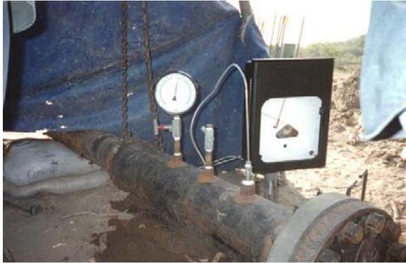
Por tratarse de tubería nueva que nunca ha estado en contacto con ningún tipo de producto químico, **el agua que ha sido utilizada en la prueba hidrostática no requiere de ningún tipo de tratamiento**, por lo que es práctica común a nivel internacional el darle la disposición que se desee (disponerla en cuerpos de agua, utilizarla para riego, etc.), ya que no se modificaron sus características fisicoquímicas originales durante la prueba.
