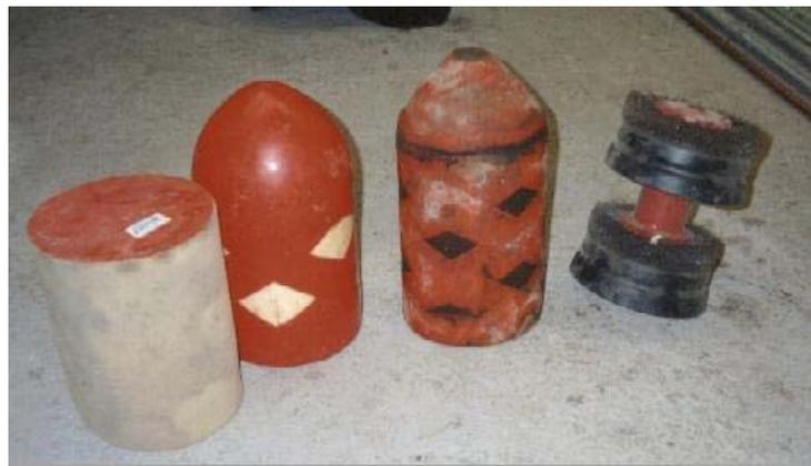
**Se correrán diablos de limpieza antes y después de realizar la prueba hidrostática, para limpiar y secar perfectamente el interior del ducto.**
