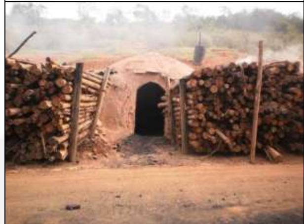
Foto 12: Unidade de Carbonização
