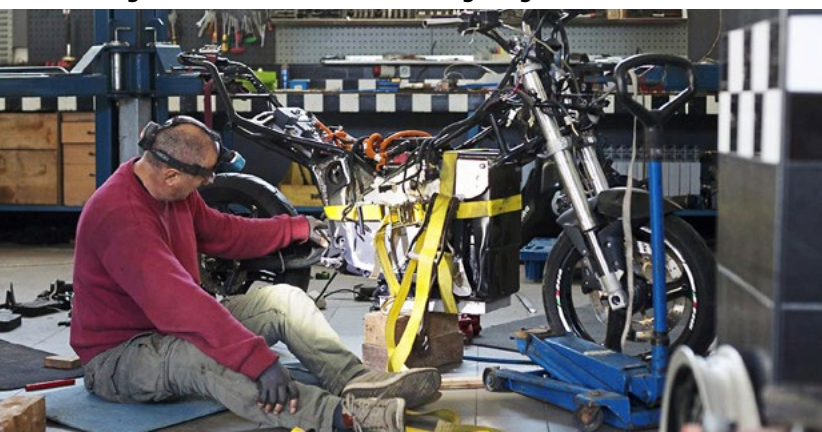
Moment der Wahrheit: E-Antrieb und Duc-Rahmen fluchten bestens
