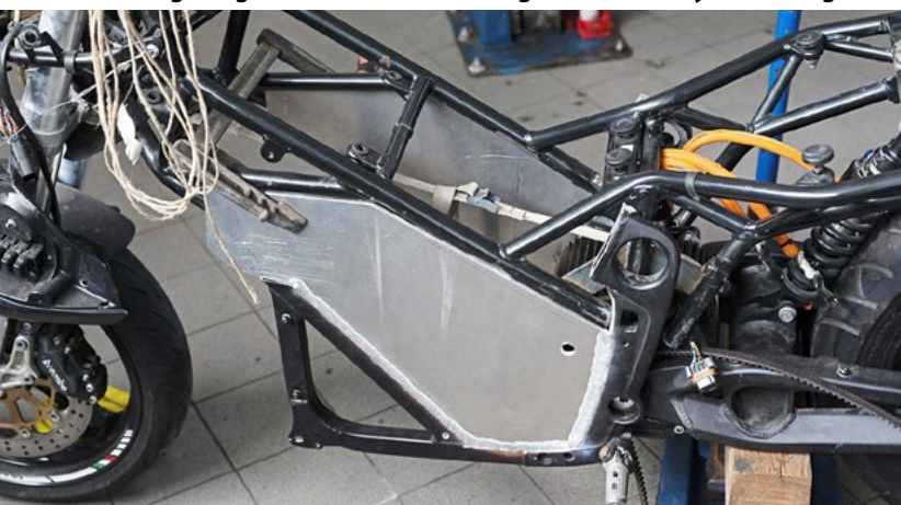
Mittig die Akkuaufnahme, ab Schwinge angeschweißtes Zero-Hinterteil
