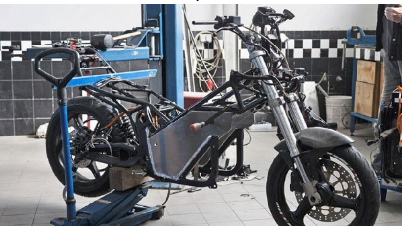
Nach tagelanger Arbeit war das Rolling-Chassis des Hybrids fertig
