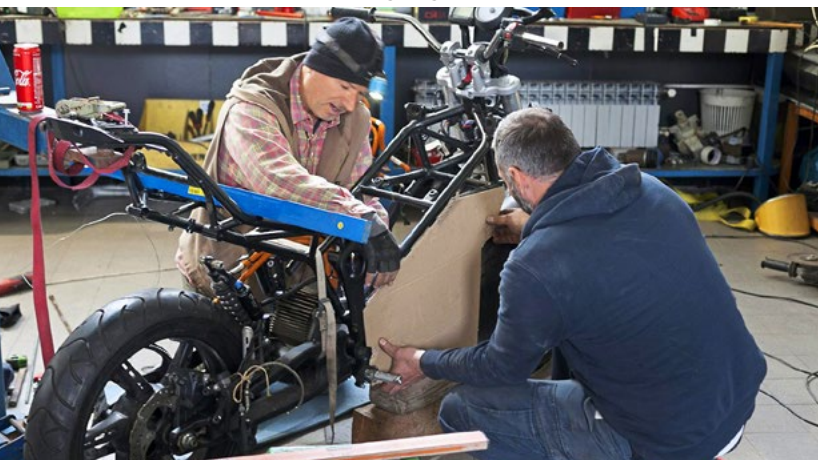
Per Pappschablone wurden die Aufnahmen für den Akku angepasst
