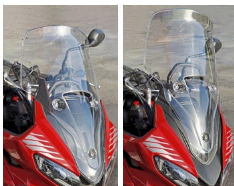
Um 83 Millimeter lässt sich die Scheibe mit einer Hand höhenverstellen, auch in Fahrt
