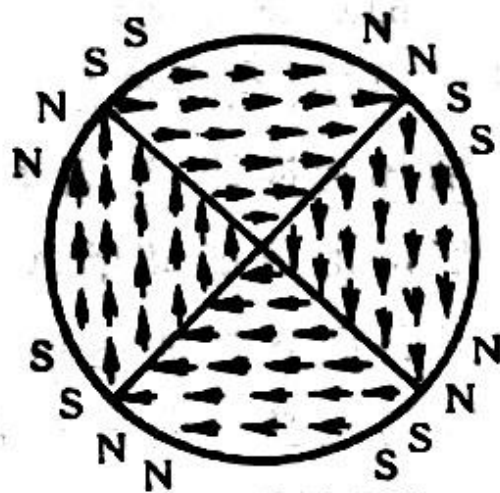
(c) 有立方各向异性的磁畴结构
