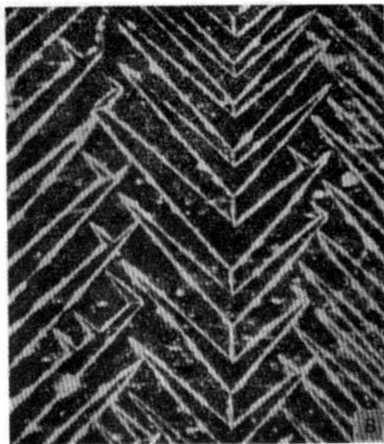
(b) 在同一表面上经过电解抛光后的粉纹图型.
