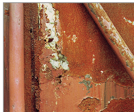
Σχήμα 1: Άχρηστο αντικείμενο λόγω διαβρώσεως
