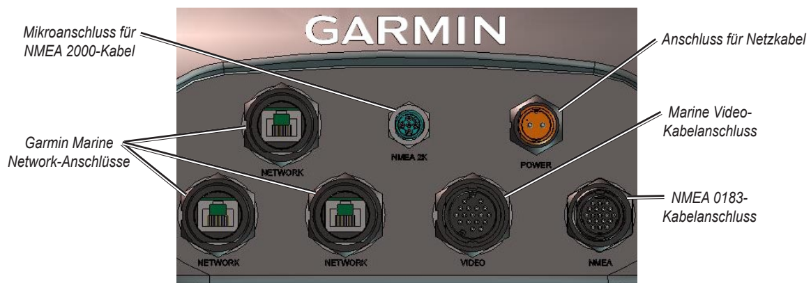
Anschlüsse an Geräten der Serie GPSMAP 4000/5000
