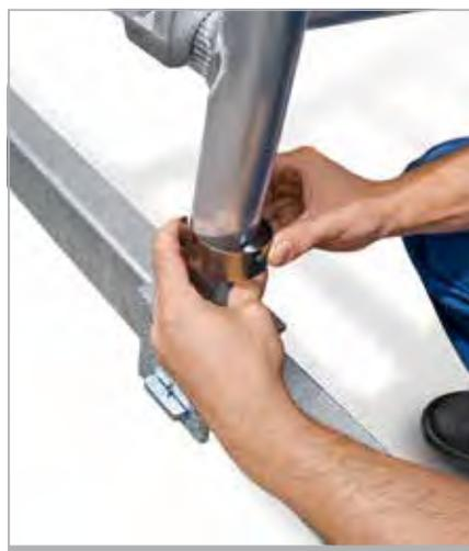
... und mit Federclips befestigen
