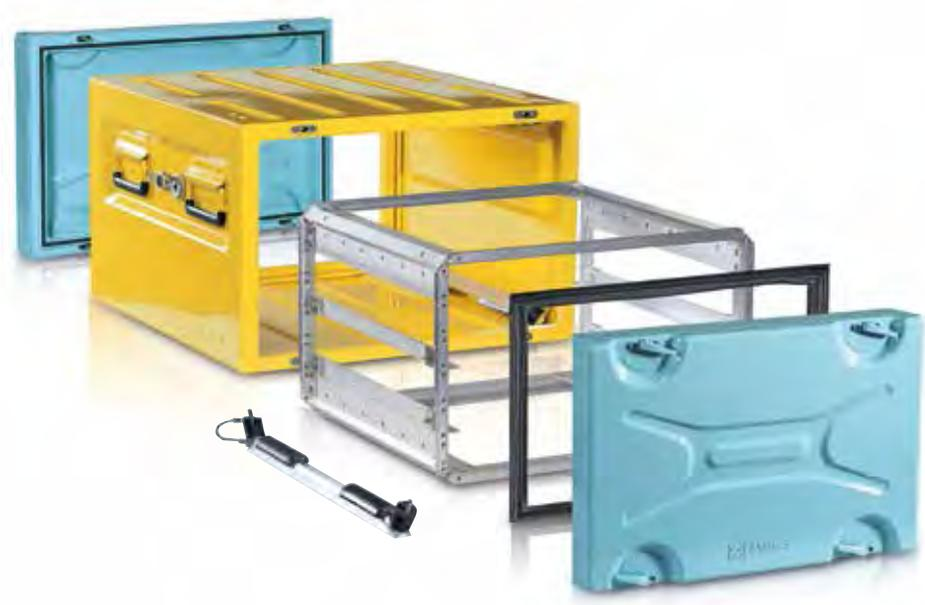
Mitraset® 19" Gehäuse sind für die Aufnahme von Elektronik-Geräten im 19-Zoll-Raster konzipiert. Sie erfüllen vielfältige Schutzfunktionen: Abhalten mechanischer Belastungen wie Stoß, Schlag und Schwingungen, Schutz vor elektromagnetischen Störungen wie Radiowellen, Blitzschlag, sowie vor allgemeinen Umwelteinwirkungen wie Hitze, Feuchtigkeit, Staub. Um diese Anforderungen zu erfüllen, sind Mitraset® 19" Gehäuse wie folgt ausgeführt:
