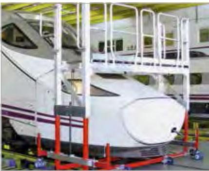
Höhenverstellbare Frontarbeitsbühne mit Schienenfahrwerk
