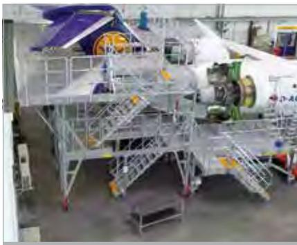
Höhenverstellbares Heck- und Triebwerksdock für eine CRJ900
