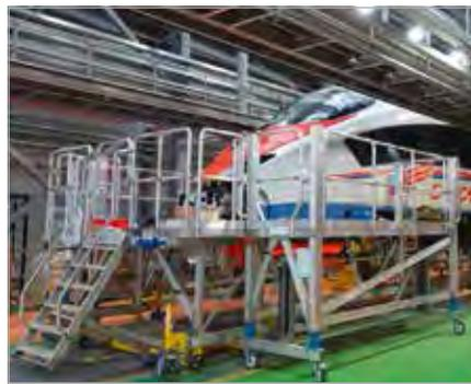
Modulares Arbeitsbühnensystem für Front- und Seitenzugang
