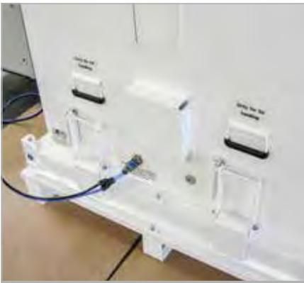
Wasserdampfdichter Behälter bei Dichtheitsprüfung durch Überdruck
