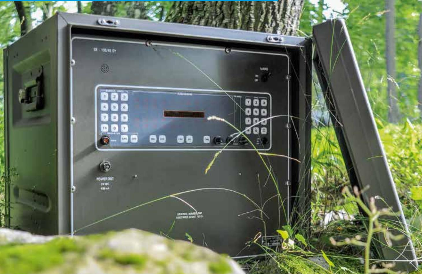
ZARGES bietet eine Reihe von Groß- und Spezialbehältern zur unterschiedlichsten Verwendung, z. B. als Transport- und Lagermittel von Flugkörpern, empfindlichen Geräten, Gefahrgut oder zum Betrieb von Elektronikkomponenten. Konstruiert und gebaut mit Blechen und Profilen aus hochfesten Aluminiumlegierungen.
