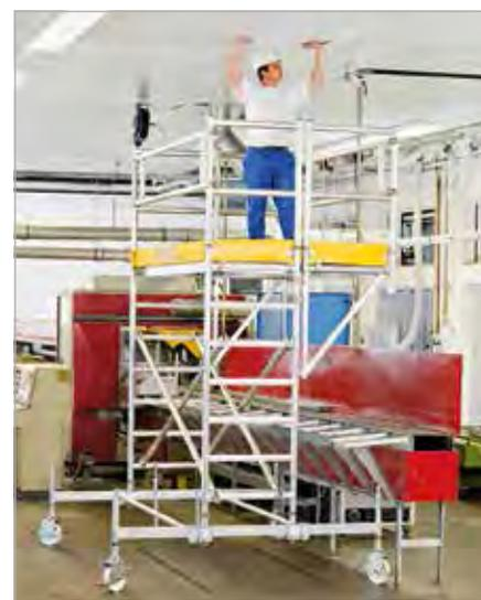
Konsolen können in drei Längen (1,80 m; 2,50 m und 3,00 m) an Fahrgerüste mit Fahrbalken bis zu einer Arbeitshöhe von 8,60 m angebaut werden.
