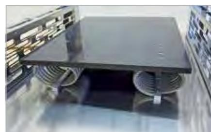
Plattform mit Dämpferelementen
