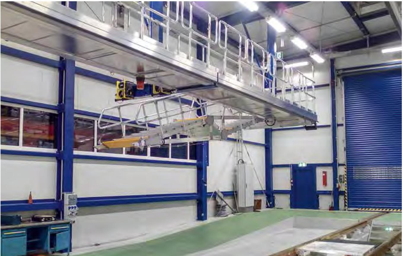
Schwenkbare Treppenlösung mit Zwischenpodest
