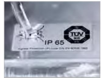
Strahlwasserschutz nach Norm IP 65
