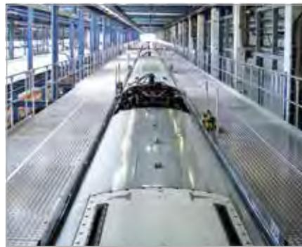
Dacharbeitsstand mit ca. 920 m Länge für ICE-Wartung
