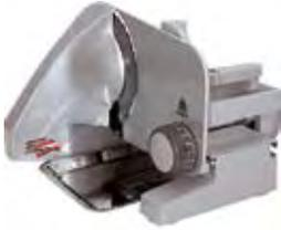
Vollmetallausführung, Getriebe-Kondensatormotor: ca. 170 Watt/230 Volt, gezahntes Messer aus rostfreiem Edelstahl, Ø 170 mm, vollgehärtet, stabile Messerlagerung durch hartverchromte Metallagerbolzen, großer Schlitten mit Edelstahlauflage, Sicherheitsschaltautomatik, Kindersicherung durch Schlittensperre und Messerabdeckung, Kabelfach, Resthalter, Edelstahl-Tablett
