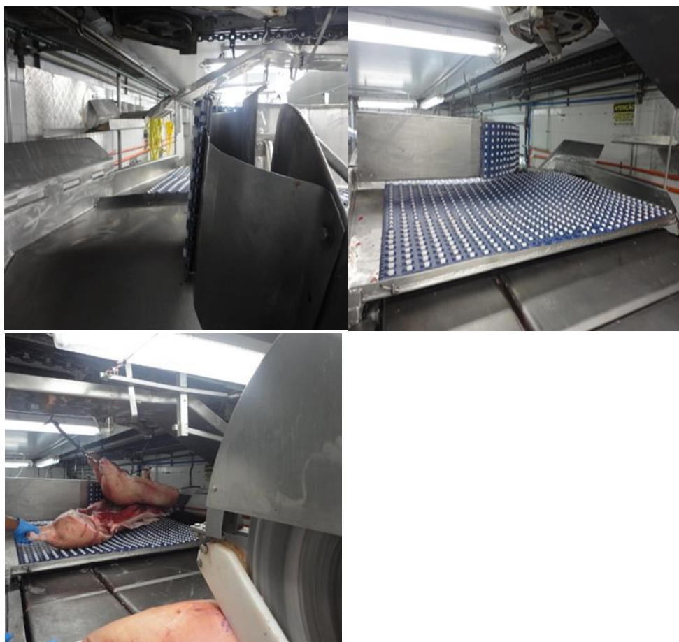
Figura 18: Calha e rampa que antecede o mezanino.
