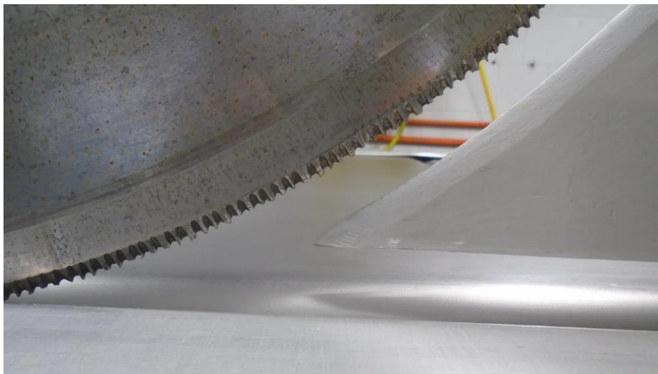
Figura 11: Disco serra utilizado na divisão de pernis em 2016.
