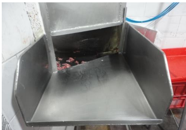
Figura 17: Entrada do chute no setor de espostejamento ligado ao setor de subprodutos.
