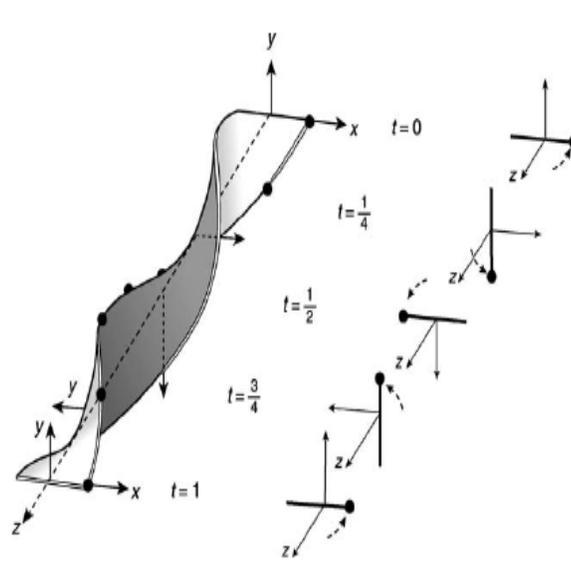
Figura 6.5: Cada sección del cinturón define un marco en  $\mathbb{R}^3$  anclado en la línea transversal del cinturón y la normal de la superficie del cinturón en ese punto.
