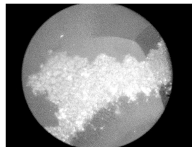
3.i ábra Előmelegített porcelánon megjelenő hajszálrepedés
