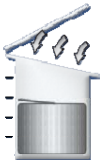
Kamra nyitva, leáramló ventilátor bekapcsolva
