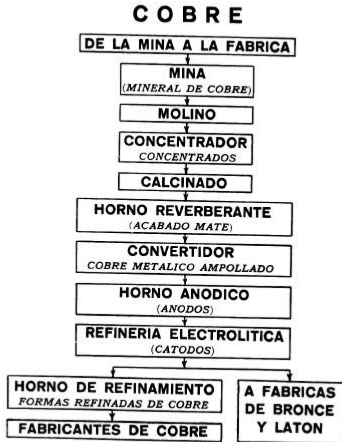
Figura 4A-6. Sistema de extracción y refinado del cobre.
