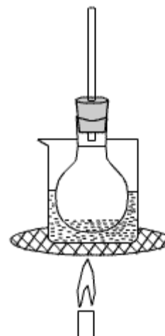
Obr. 1 Esterifikace za použití jednoduchého zpětného chladiče
