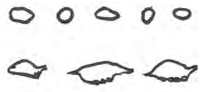
Fig.1 Tipi delle varie sezioni rilevate nei condotti.
