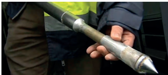
Figure 1 : Pointe de sondage de l'essai au pénétromètre
