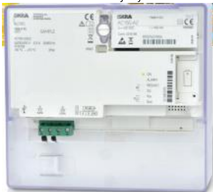
Slika 2: Podatkovni koncentrador (Gateway) za G3 PLC komunikacijo AC750 (vir IskraEmeco, 2019, stran 1)
