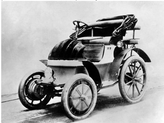
Slika 8: Prvo vozilo z in-wheel pogonom Lohner-Porsche
