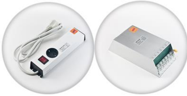
Slika 12: Enofazni PLC filter (levo) in trifazni PLC filter (desno) s katerima filtriramo visokofrekvenčne motnje hišnih naprav (inverterji, VF elektronska stikala, napajalniki) v G3 PLC komunikaciji (vir BRS, 2018, stran 1)
