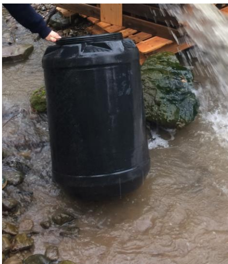
Slika 27: Merjenje pretoka s pomočjo PVC soda (vir: lasten)
