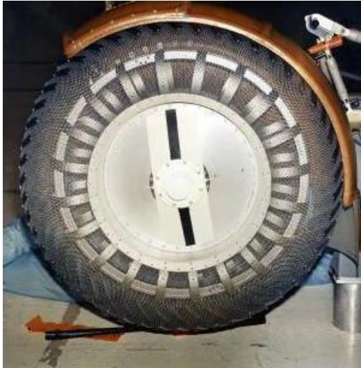
Slika 9: Pogon lunarnega vozila – lunarni rover je imel manjši motor z 10000 vrtljaji montiran v kolesu motorja (Hub motors)
