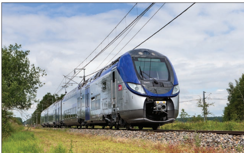
4. ábra: Az Omnio (Regio 2N) egy és kétszintes egységekből összeállított villamos motorvonat
