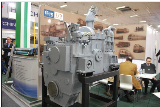
15. ábra: A Ganz H122-15 típusú hidrodinamikus hajtóműve (fotó Kovács K.)
