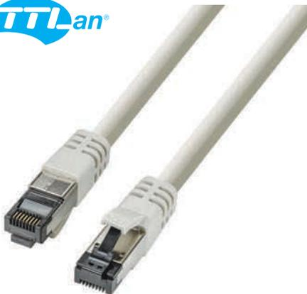
**Spezifikation****Steckertyp:** 2x RJ45 8P8C**Kategorie:** 8**Umspritzung:** ja**Kontakte:** 50µ Goldauflage**Kabel:** Innenleiter 100% reines Kupfer**Kategorie:** 8**Aufbau:** S/FTP (PiMF) 4x2x**AWG:** 24**Außendurchmesser:** 8,0±0,2 mm**Mantelmaterial:** LSOH**Farbe:**  hellgrau**Art.Nr.** 1922HF-x,xM**Verfügbare Längen:** 0,5 / 1,0 / 2,0 / 3,0 / 5,0 / 7,5 / 10,0 / 15,0 / 20,0 / 25,0 Meter (x,x = Länge)**Technische Daten****Übertragung:**
