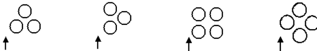
a) 30°-os elrendezés b) 60°-os elrendezés c) 90°-os elrendezés d) 45°-os elrendezés
