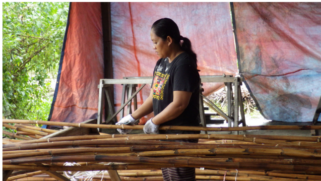
写真 9 : 表面の節を滑らかにする。
