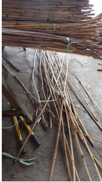
写真13：下のラタンは、細すぎて規格外。
