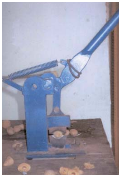
Figura 7. Equipamento manual para quebra de frutos de baru, projetado por J. C. Madeira (Foto: S. M. Sano).
