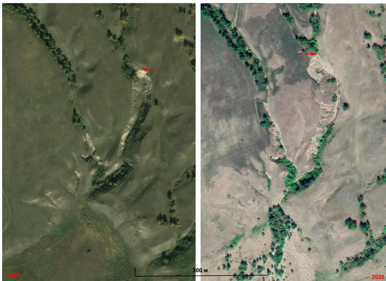
Рис. 82. Рост оврага на высокой террасе р. Туба, примыкающей к юго-восточному склону г. Песчаная (2,45 км к востоку от с. Кавказское) с 2005 по 2020 г. Стрелкой указано положение вершины оврага в разные годы.
