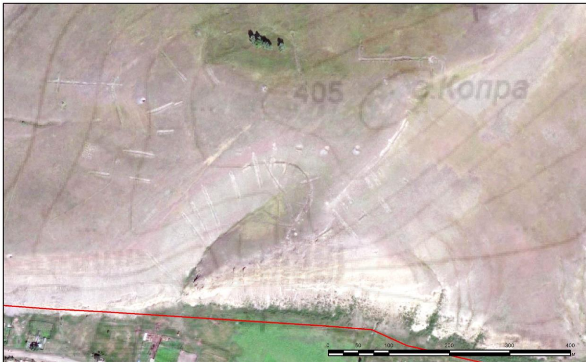
Рис. 86. Геологоразведочные каналы на склоне г. Копра
