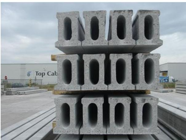
**Sección hueca o tubular:** Las correas de sección hueca o tubular son parecidas a las placas alveolares, pero con un solo alveolo (o dos a lo sumo) y por tanto de ancho menor. Se utilizan para soportar el peso de cubiertas con luces de hasta 18 m aprox. También empleadas como vigueta, en sistemas de vigueta y bovedilla.
