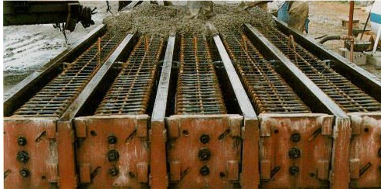
Los pilotes se equipan en su fabricación con una pieza metálica en la punta, para protección del hormigón durante la hinca, y de un zuncho de refuerzo, también metálico, en la cabeza de golpeo.
