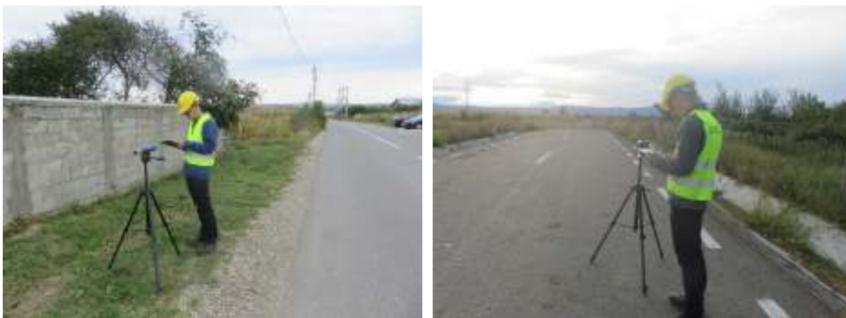
Foto 6.4. Măsurarea nivelului de zgomot
