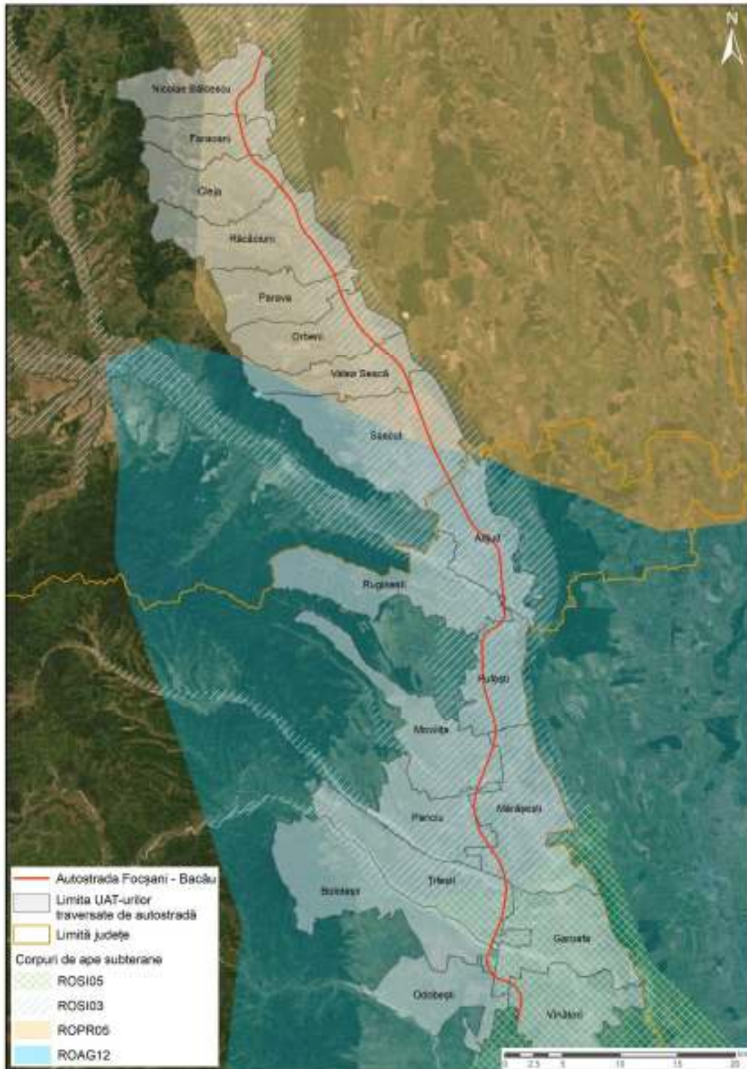
Figura 3.43. Corpurile de apă subterană traversate de proiect
