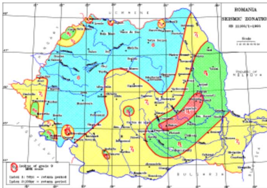
Figura 10 – Zonarea seismica SR 11100-1:93
