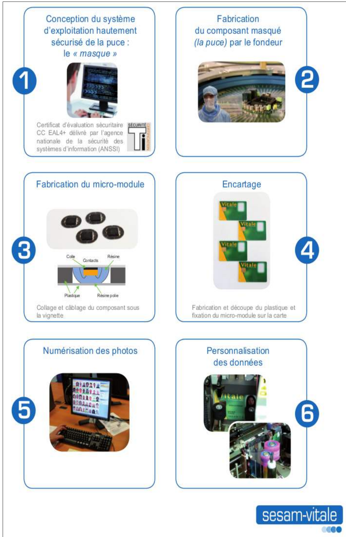
Illustration 25 - Les étapes de fabrication de la carte Vitale identiques à celle d'une carte à puce.[1]
